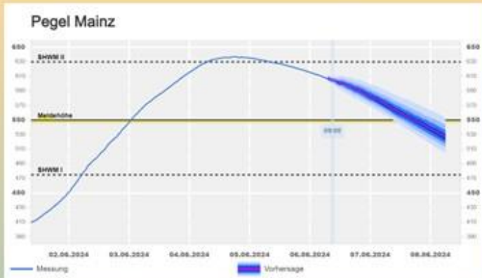
Pegelverlauf Anfang Juni. Typisch ist der rasche Anstieg und der langsame Rücklauf.
